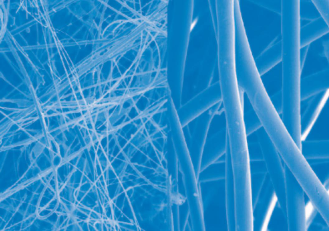
Un des points clés dans les filtres à air est le diamètre des fibres. Plus la fibre est fine, plus l'efficacité de rétention est grande. La caractéristique la plus reconnue des filtres haute efficacité de Camfil Farr est l'excellente combinaison de fibres fines capturant des plus petites particules avec une construction spécifique minimisant la consommation d'énergie pendant toute la durée de vie.
