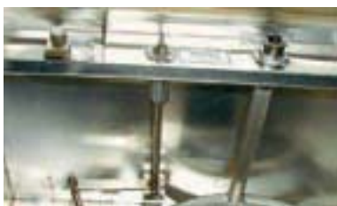
Aerosolspridningssystem med QD-öppningar (Quick Disconnect, snabb avstängning) och spjällstyrningsmekanism.
