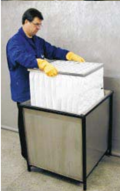
Testinstitutet VTT i Finland. Urladdning av filter med isopropanol.
