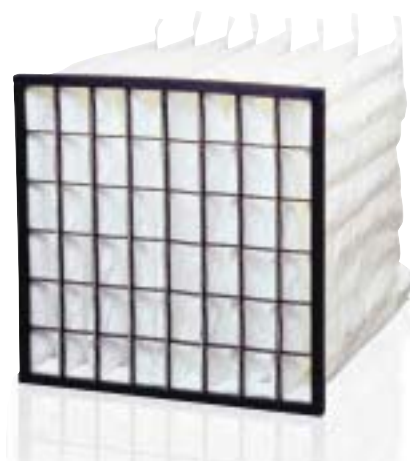
Ett P-märkt syntetfilter med fina fibrer som inte tappar sugen är Camfil Farris Cam-Flo. Det första på marknaden fungerande syntetfiltret. Efter urladdning är avskiljningen 50 % och filtret är därmed fortfarande ett klass F7 filter.
