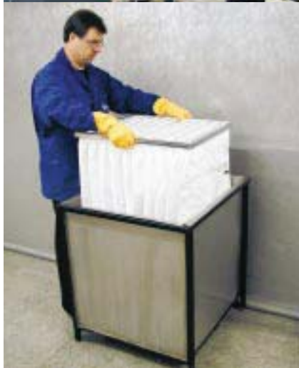
Centre d'essai VTT en Finlande. Déchargement de filtres avec de l'alcool isopropylique.
