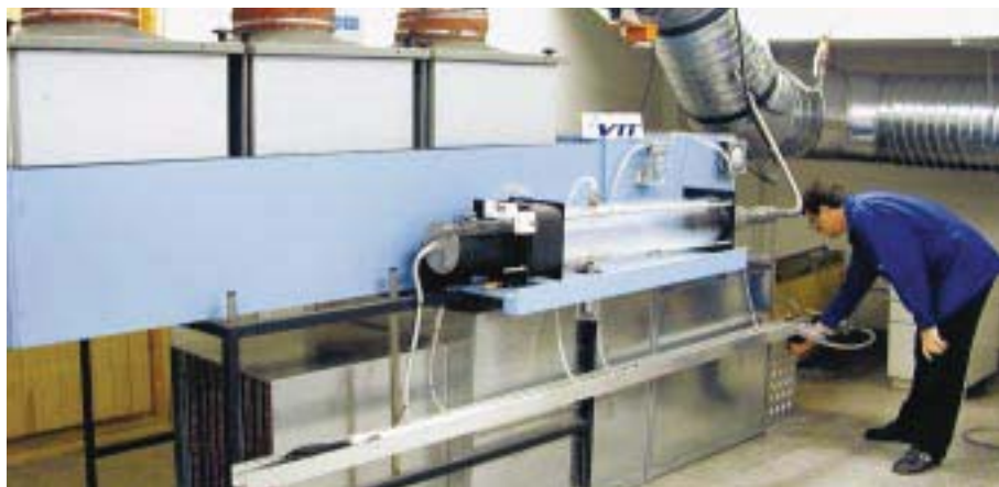
Essais selon la nouvelle norme EN 779:2002 au VTT en Finlande
