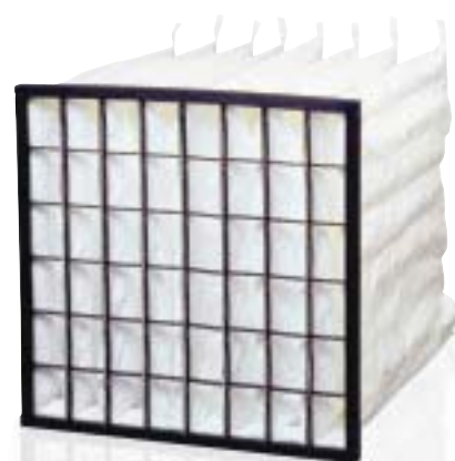
Le Cam-Flo de Camfil Farr, est un filtre synthétique certifié P-mark à fibres fines, dont l'efficacité reste constante. C'est le premier filtre synthétique efficace du marché. Après déchargement, l'efficacité atteint 50 % et le filtre peut toujours être classé F7.
